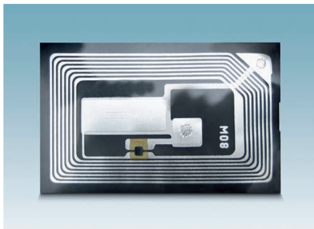
Obr. 2 RFID HF transpondér sa skladá z antény, pamäťového čipu a nosiča.
