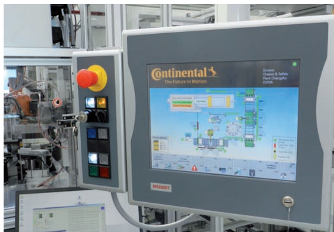
Obsluha linky má k dispozícii operátorský panel Beckhoff, ktorý ponúka vizualizáciu celej linky, jej stavov, alarmových hlásení či možností nastavovania niektorých procesov.
