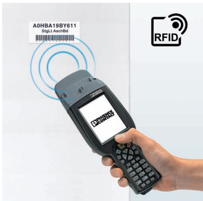
Obr. 1 Nový spôsob označovania – prostredníctvom zapisovacieho a čítacieho zariadenia sa informácie bezkontaktné zapisujú na RFID transpondér, z ktorého sa dajú späťne prečítať.
