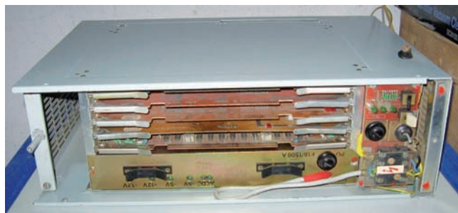
Obr. 9 Kazetové prevedenie mikropočítača SM 50/40-1 používané pre riadenie technologických procesov.
