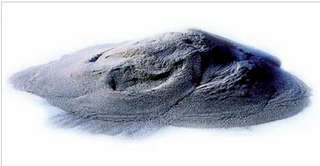
Nehrdzavejúca oceľ (GP1) vo forme prášku [3]
